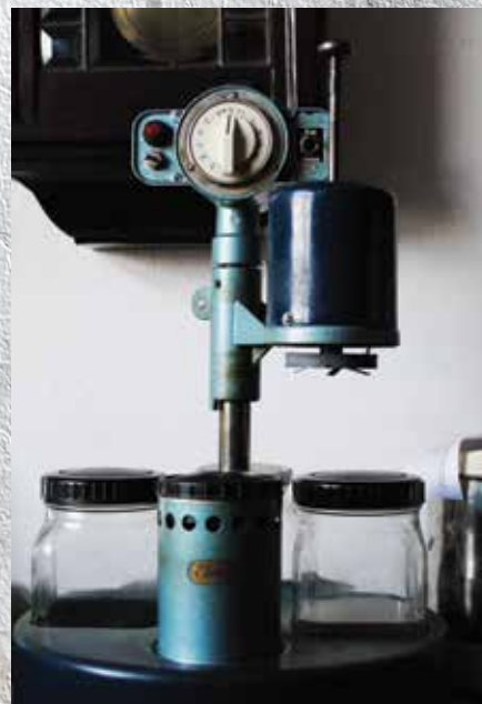
Czyszczarka – specjalne urządzenie wykorzystywane podczas gruntownej naprawy zegarka.
